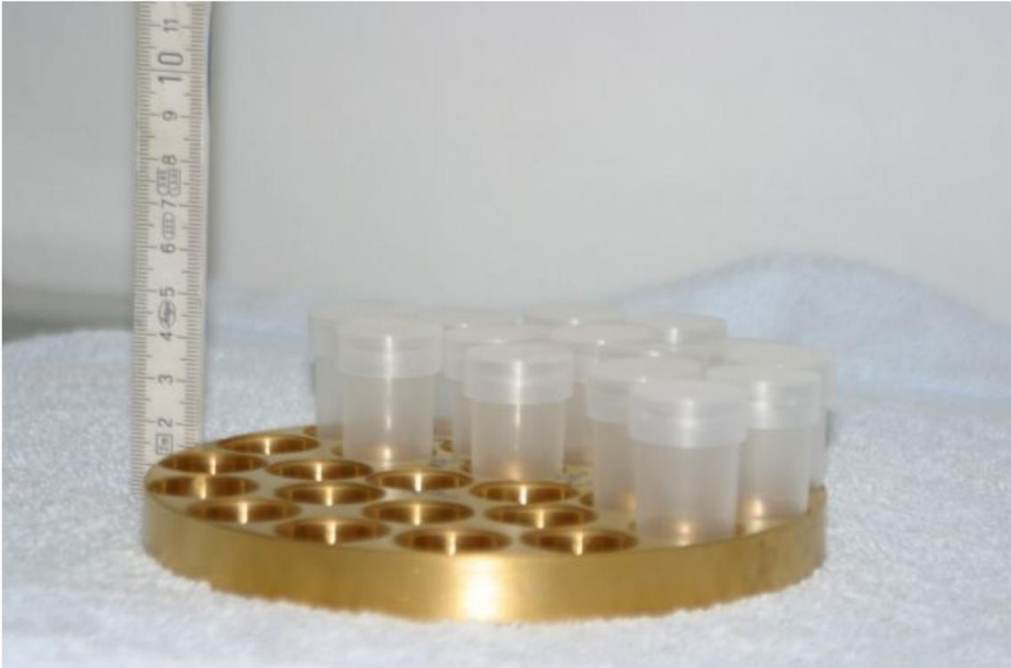
Abb. 16: Kunststofftiegel zum Einsatz in der isopiestic Messapparatur
