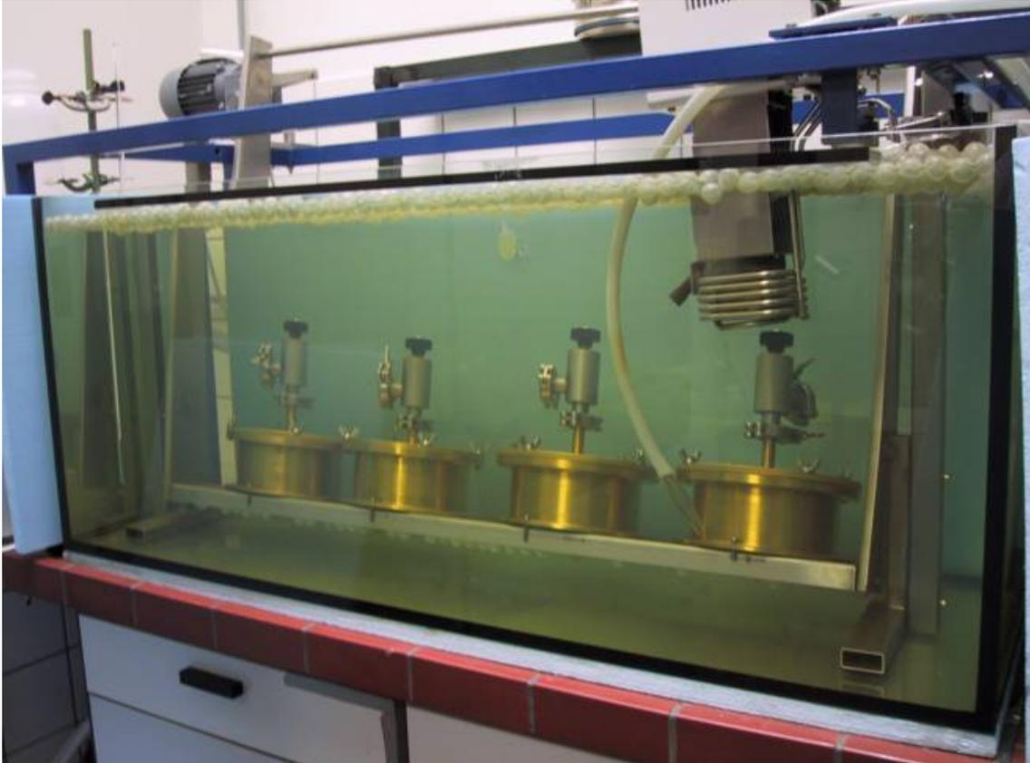
Abb. 14: Isopiestic Messapparatur mit vier Töpfen, entsprechend vier isoaktivitätslinien.
