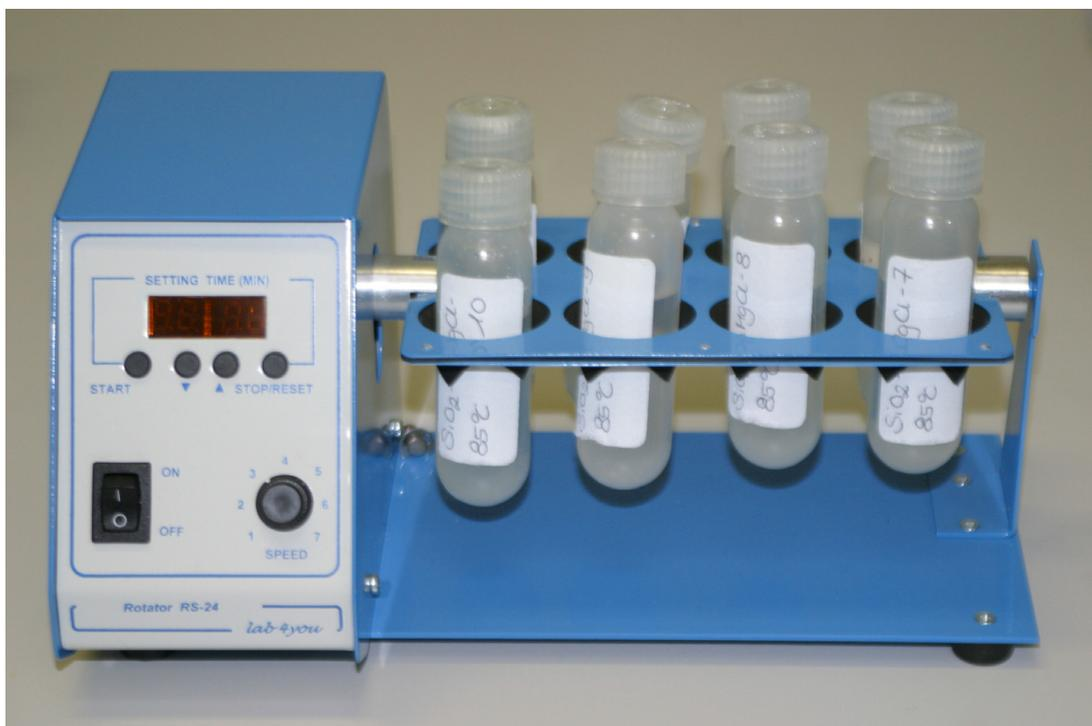
Abb. 1: Überkopfschüttler für die Löslichkeitsversuche
