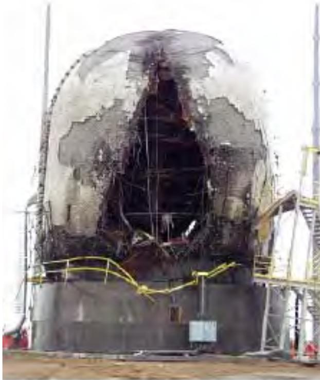
**Abb. 5-5** Schadensbild nach Versagen des SANDIA-Modellcontainments (aus /HES 03/)
