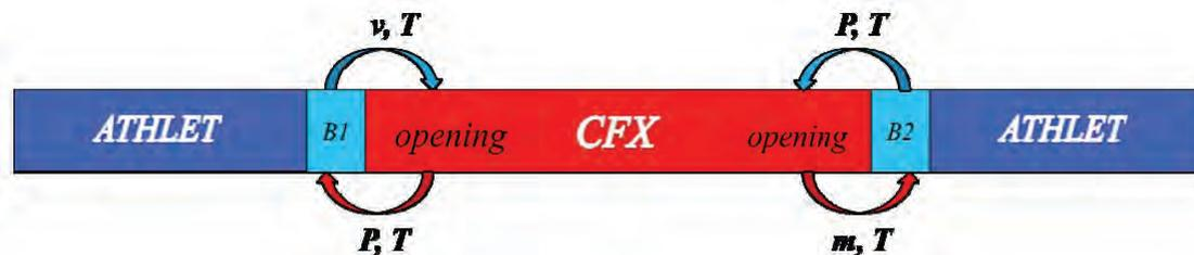
**Bild 3.1-49** Thermohydraulische Austauschgrößen mit Opening – Opening Randbedingungskombination
