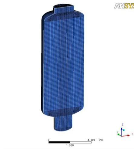
Abb. 2-110 CFD-Gitter bei der Simulation des HD-2R Experiments
