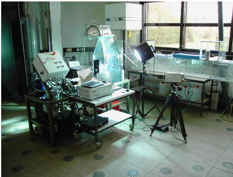
Abb. 3.12: Hochgeschwindigkeitsvideokamera und Lichtquelle zur Dokumentation des Verformungs- und Freisetzungsvorgangs.
