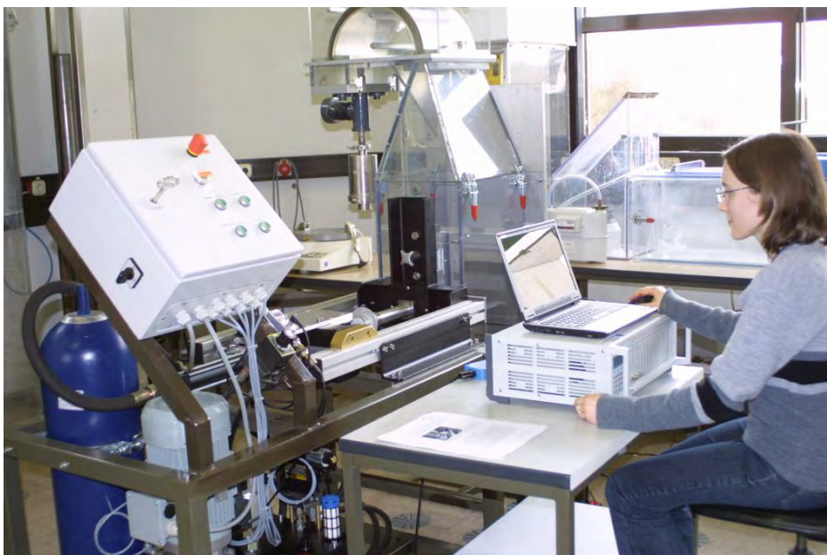
Abb. 3.7: Belastungsprüfstand mit Vorrichtung zur Erfassung und Charakterisierung der Freisetzung.
