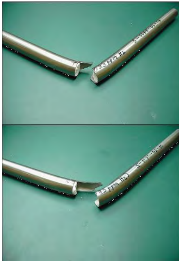
Abb. 4.8 Schadensbild nach Hauptversuch H4 (oben) und H10 (unten).
