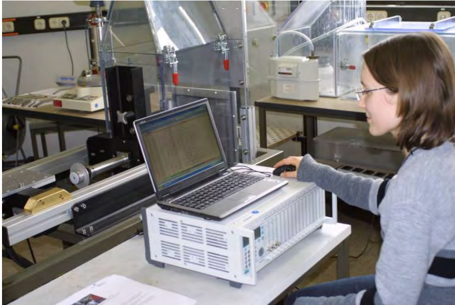
Abb. 3.10: Messdatenerfassungssystem und angeschlossener Bedien-PC.
