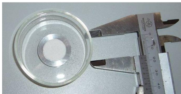
Abb. 10 Presstablette für die LA-ICP-MS-Analyse (Durchmesser 17 mm) am Beispiel einer Standardprobe. Die Reinigung der Presswerkzeuge mit verdünnter Orthophosphorsäure im Ultraschallbad führte zur Anlösung der Oberfläche. Daher wurden die Gerätschaften herkömmlich mit milden Tensiden gereinigt
