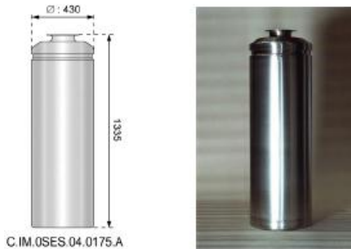
Abb. 2.3 Schematische Darstellung und Foto einer CSD-V/AND 05/
