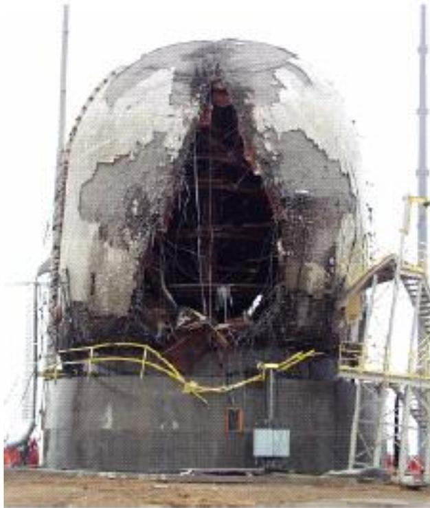
Abb. 6.1-2 Schadensbild nach Versagen des SANDIA-Modellcontainments (aus /HES 03/)
