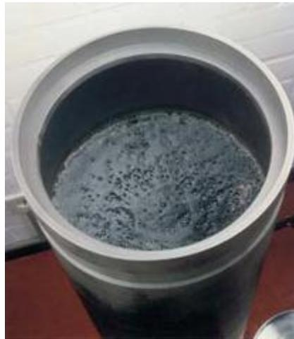
**Abbildung 3-5:** Verglaste Spaltprodukte in einer unverschlossenen Kokille /BFS 05/
