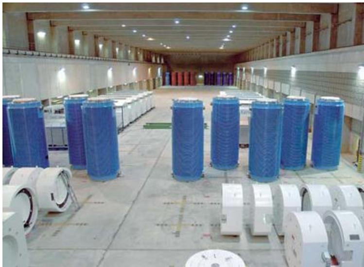
**Abbildung 2-2: CASTOR-Behälter im Transportbehälterlager Gorleben /BFS 05/**
