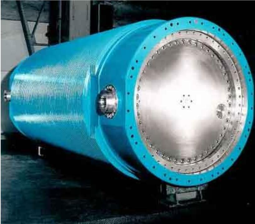
**Abbildung 3-25:** Beispiel eines CASTOR V/19-Behälters ® (Quelle: BAM)
