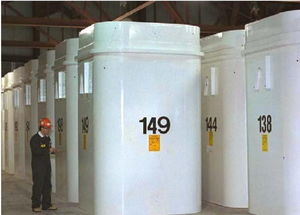
**Abbildung 2-12:** OPG-Trockenlagerbehälter /STE 07/
