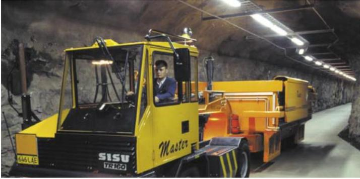
Abb. 2.13: Transport von mittelradioaktiven Abfallgebinden über eine Rampe in Olkiluoto /FEI 07/
