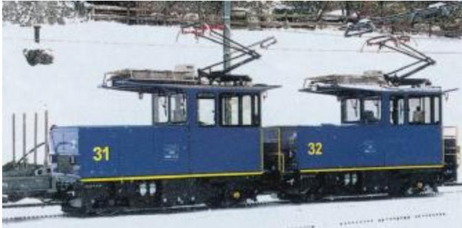
Abb. 2.6: Beispiel einer Zahnradlokomotive – Hgea 2/2 in Doppeltraktion /NAG 02/
