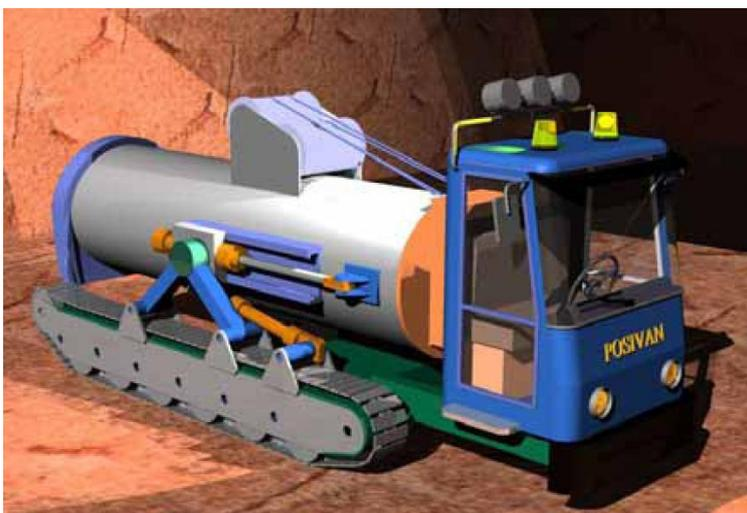
Abb. 2.8: Konzept Transport- und Einlagerungsfahrzeug für Abfallbinde /POS 07b/
