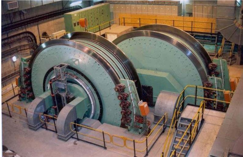
Abb. 5.1: 4-Seil-Fördermaschine mit integriertem Motor (Foto: SIEMAG)
