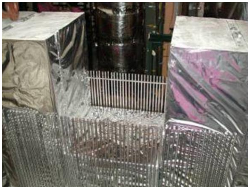
Abb. 3-12 Zusammenbau der Betonkomponenten (Seitenwände und Boden, in Folie verpackt) und Elektrodenbänke vor dem Hinzufügen der inerten Seitenwände (aus MgO) hinter den Elektrodenbänken für die CCI-Versuche /FAR 06/
