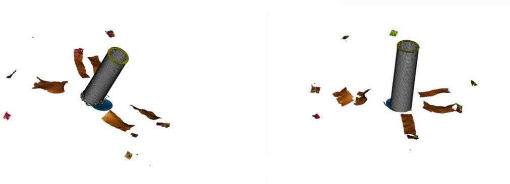
Abb. 6-17 Bruchbild des Projektils in TF13 mit (links) und ohne (rechts) Aktivierung von stochastischem Materialversagen
