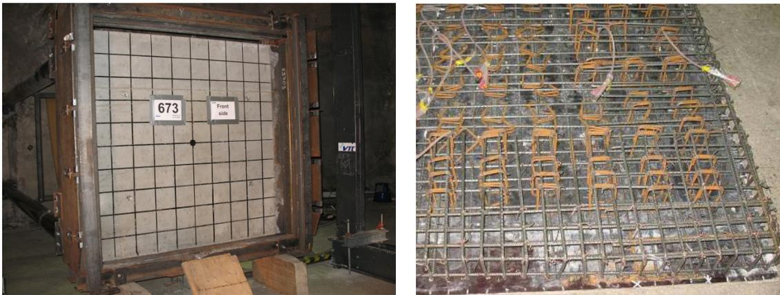
Abb. 6-1 Versuchsplatte im Stützrahmen und Bewehrungsmatten vor dem Betonieren im Versuch 673
