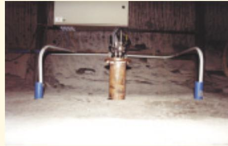
a) Foto der Bohrlochinstrumentierung
