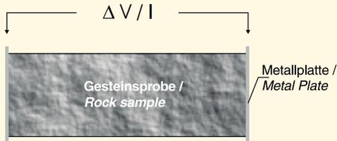
a) Vertikalschnitt durch die Versuchsanordnung
