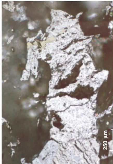
▲ Dünnschliffmikroskopie der Erzminerale zur qualitativen optischen Bestimmung der im Haldenmaterial enthaltenen Minerale
