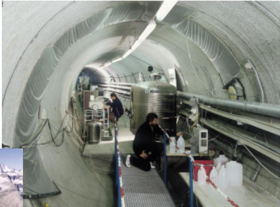
▲ Im Migrationsversuch werden im 1:1 Maßstab der Radionuklidtransport und die -rückhaltung auf ihre Wechselwirkung mit dem Gebirge untersucht. Zu sehen sind die Vorbereitungen für die Injektion von radioaktiven Isotopen ins geklüftete Gebirge.
