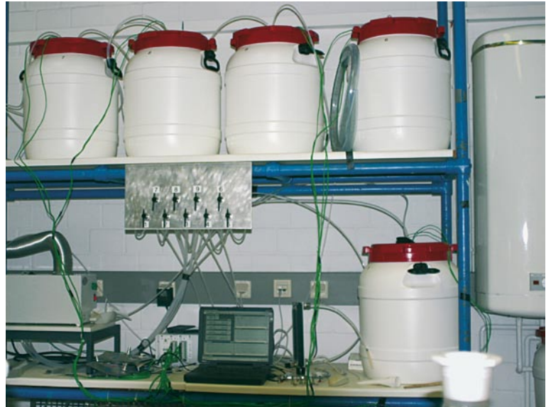
▲ Messstand mit Technikumsversuchen zur Gasfreisetzung Test set-up of pilot-plant-scale experiments on gas liberation ◀ Schematische Darstellung des Reaktionsgefäßes zur Messung der Gasfreisetzung im Technikumsmaßstab Schematic diagram of the reaction vessel for measuring gas liberation at pilot plant scale
