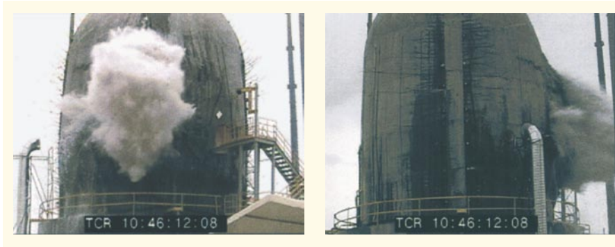
▲ Versagen des SANDIA-Modellcontainments bei 1,42 MPa (zwei verschiedene Ansichten; aus NUREG/CR-6810)
