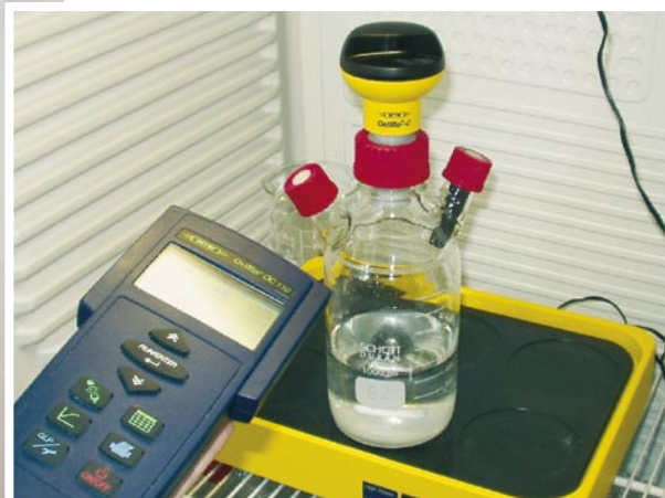
▲ Versuchsflaschen mit Druckmessköpfen zur Bestimmung der Gasfreisetzung aus Abfällen sowie mobiler Controller zum Auslesen der Messdaten über Infrarot-Schnittstelle (li.)
