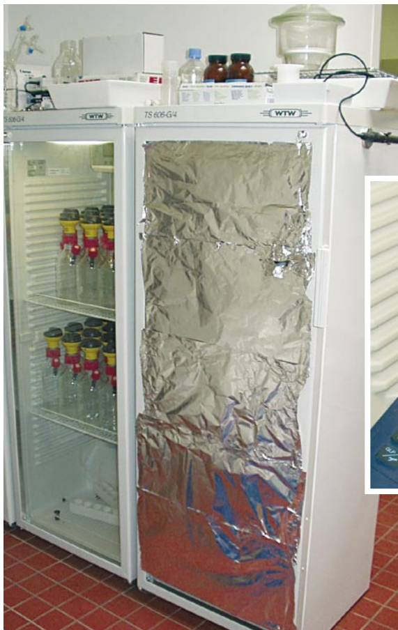
◀ Thermoschränke zur Temperierung der Gasmessflaschen auf 25 bzw. 35 ± 1 °C Heat-insulated cupboards for keeping the gas-measuring bottles at 25 and 35 ± 1 °C, respectively
