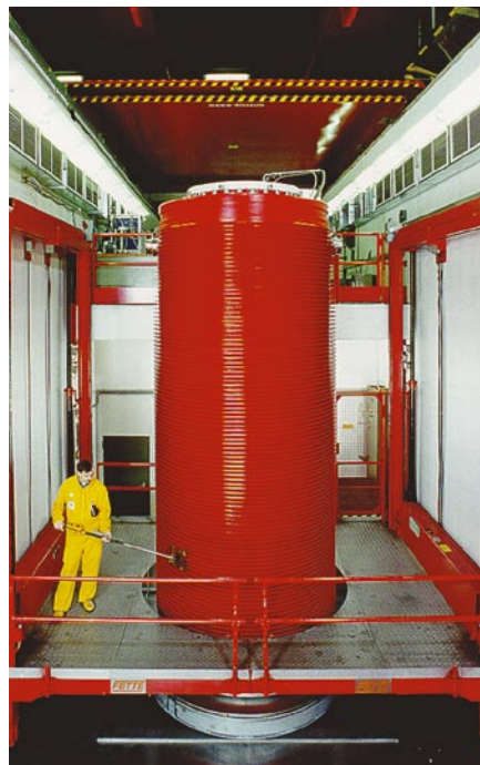
▲ Transport- und Lagerbehälter für Glaskokillen vom Typ CASTOR HAW 20/28 im Wartungsraum des Brennelementlagers Gorleben
