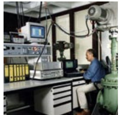
Armaturenprüfstand im ISTec-Labor zur Untersuchung von Diagnoseverfahren
