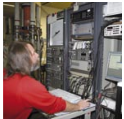
Geotechnisches Labor: Steuerstand und Messwerterfassung einer Triaxialprüfmaschine
