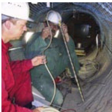
Installation von Geoelektrik-Testketten im Untertagelabor MontTerri
