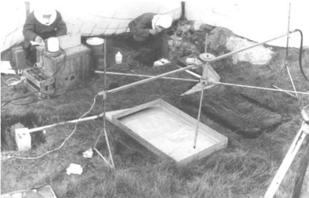
◀ Mikro-Plot im Freien zur Bestimmung des oberflächigen Regenablaufes
