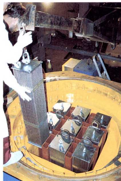
Bild 5.40: Der CASTOR-Versuchsbehälter wird mit verkürzten Brennelementen befüllt.
