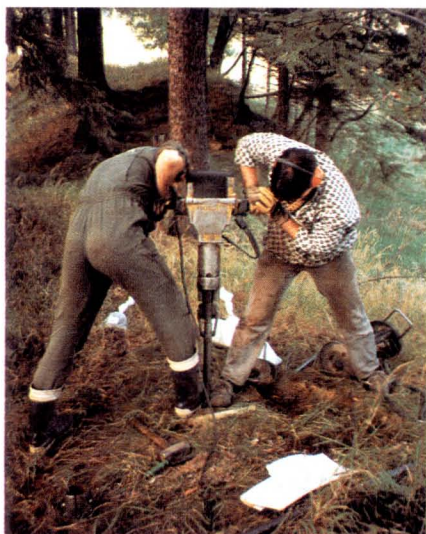
Bild 7.9: Durchführung einer Rammkernsondierung mit anschließender Probenahme aus dem Bohrkern
