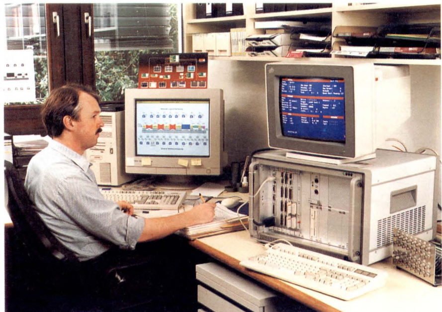
Bild 12.2: Auswertestation des Turbinendiagnosesystems VIBROCAM plus COMOS
