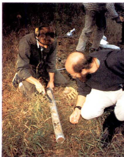
Bild 7.9: Durchführung einer Rammkernsondierung mit anschließender Probenahme aus dem Bohrkern
