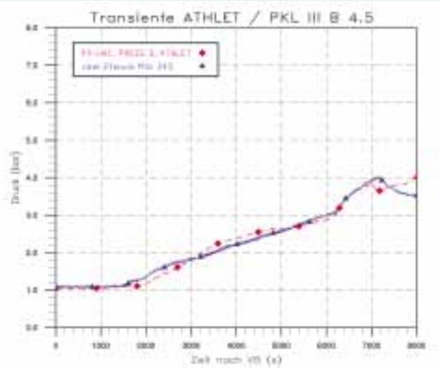
▲ Bild 2: Druck im Primärkreis (oberes Plenum)
