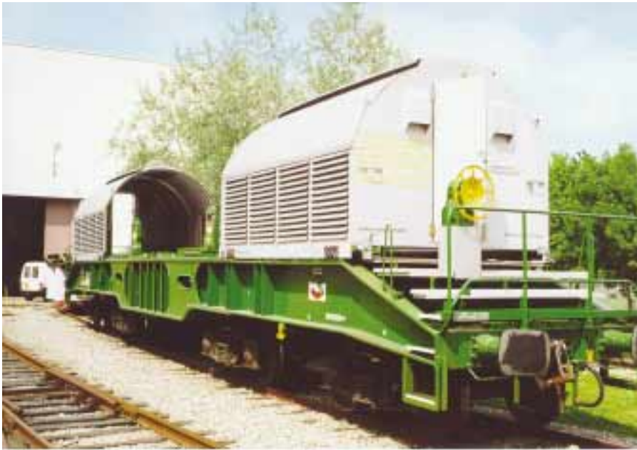
▲ Waggon für die Beförderung von Behältern mit abgebrannten Brennelementen Wagon for the transport of casks holding spent fuel elements
