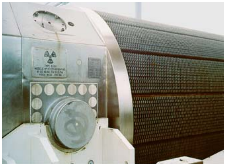
▲ TN 17/2-Brennelement-Transportbehälter: Gut sichtbar sind der Tragzapfen und der Kühlrippenbereich
