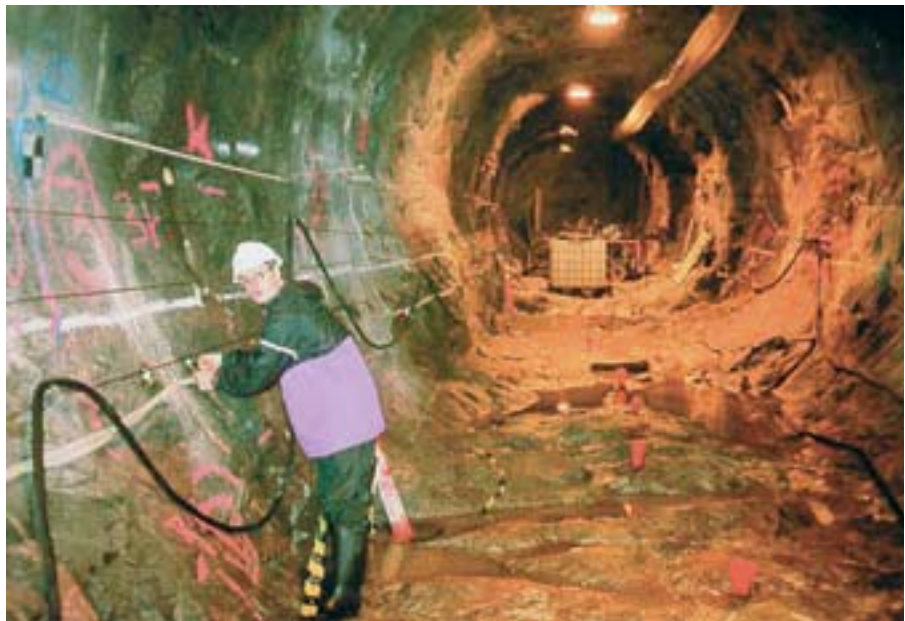
▲ Geoelektrische Messungen im HRL ÄSPÖ Geoelectrical measuring in the ÄSPÖ HRL
