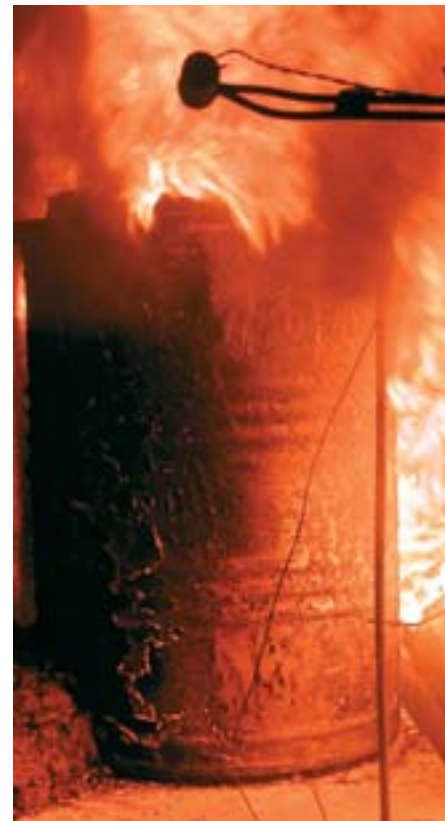
▲ Brandversuch zur Untersuchung des Aufheizverhaltens eines Abfallfasses
