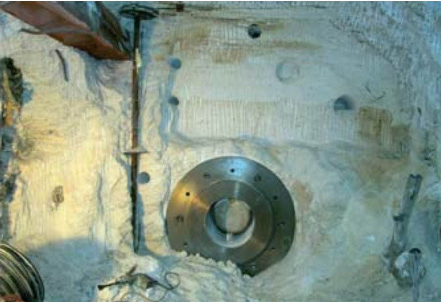
▲ Blick auf den ausgegrabenen Erhitzer in einer TSS – Strecke nach Versuchsende
