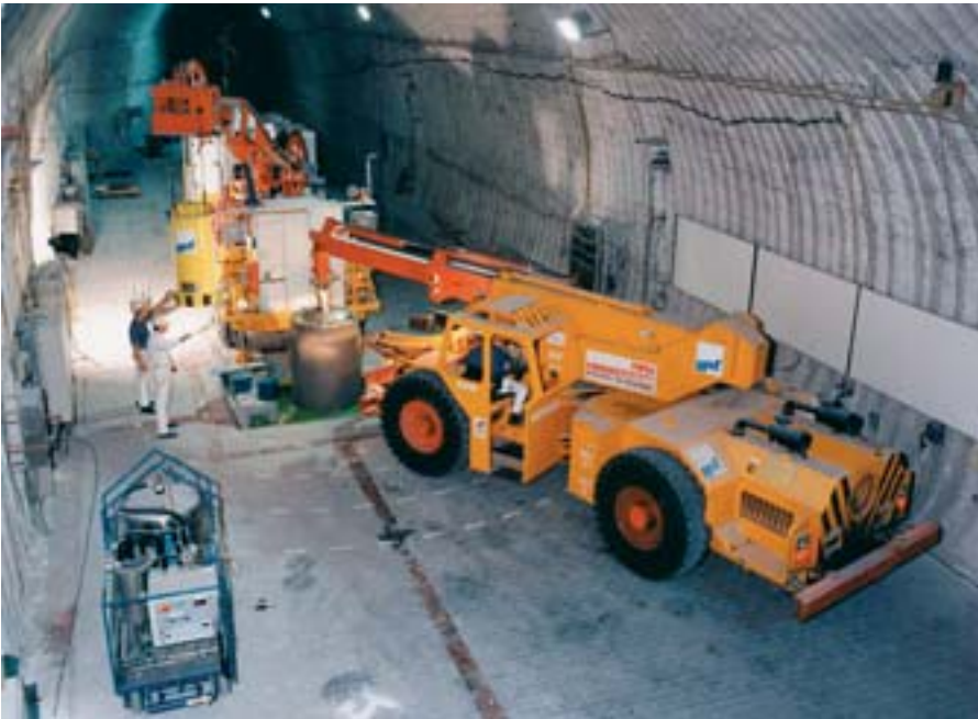
▲ Entwicklung und Erprobung eines HAW-Einlagerungssystems in der Asse (1992) Development and trial of an HAW emplacement system in the Asse mine (1992)
