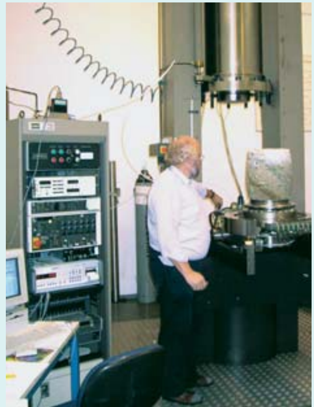
▲ Prüfkörper nach dem Triaxial-Versuch Test sample after a triaxial test
