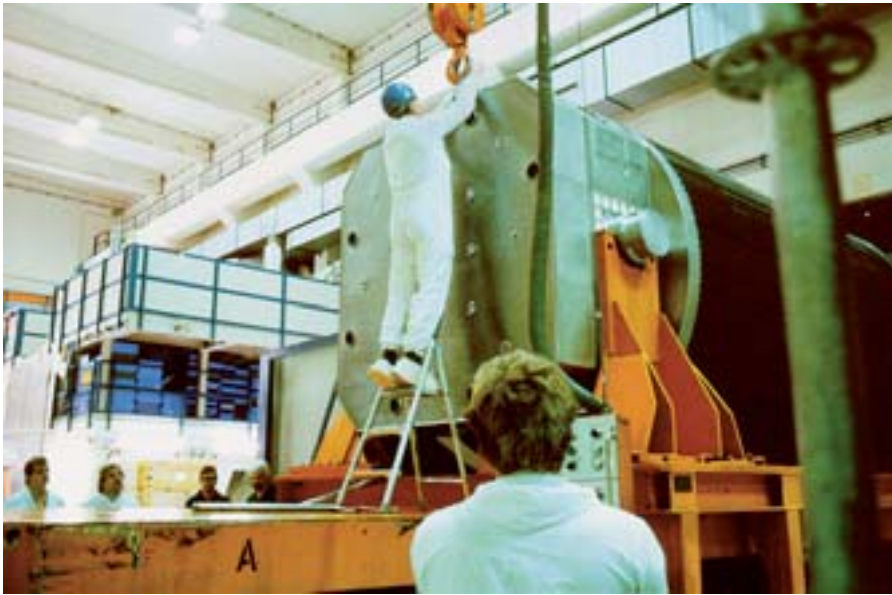
▲ Abfertigung eines Brennelement-Transportbehälters
