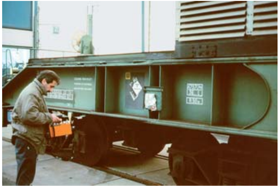
▲ Strahlenschutzmessung an einem Transportwaggon Radiation measurement on an transport wagon
