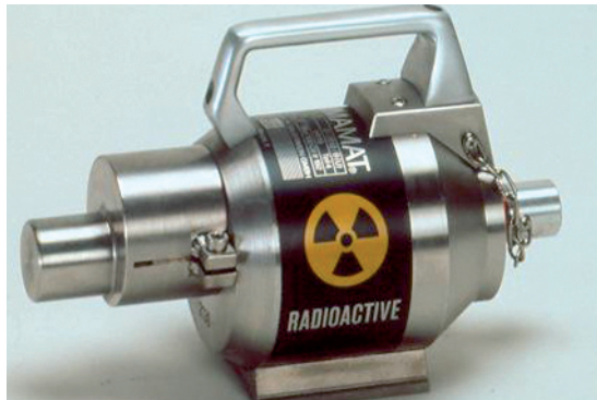
▲ Ansicht eines Gerätes GammaMat T1 für die industrielle Gammaradiografie View of a GammaMat T1 device for industrial gamma radiography
