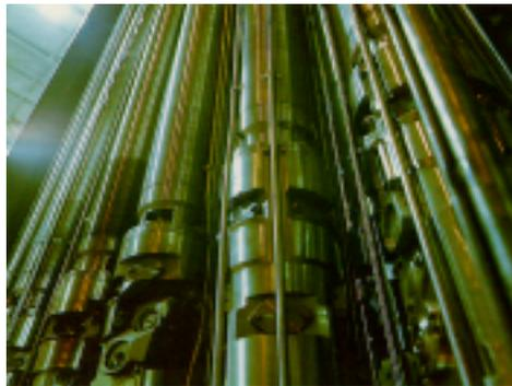
Steuerstabantrieb eines WWER
