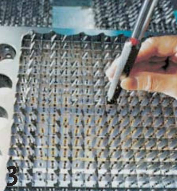
3: Abstandhalter fixieren die eingeschobenen Brennstäbe mit Federn.
