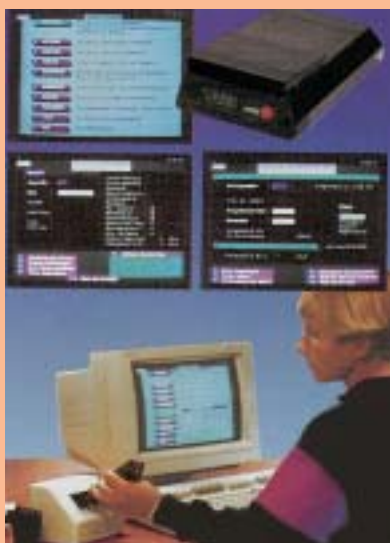
Überwachung der individuellen Personendosis: Mit dem PC-gestützten Dosimetersystem werden die digitalen Alarmdosimeter ausgewertet und die Dosiswerte verbucht.
