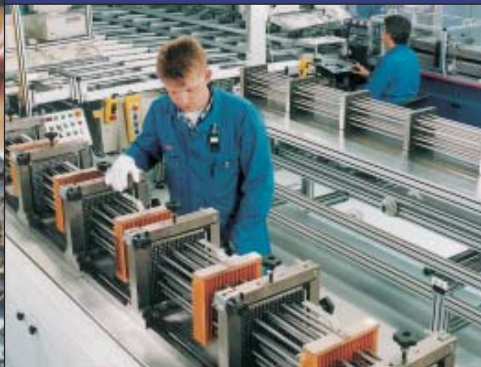
4: Die einzelnen Brennstäbe werden zu Brennelementen zusammengebaut.
