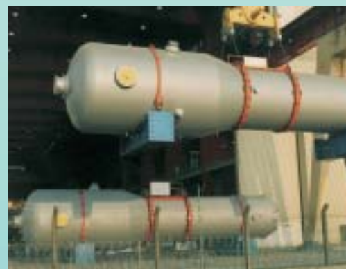
In einem Druckwasserreaktor wird das System aus Rohren, Pumpe und Dampferzeuger als Loop bezeichnet.
