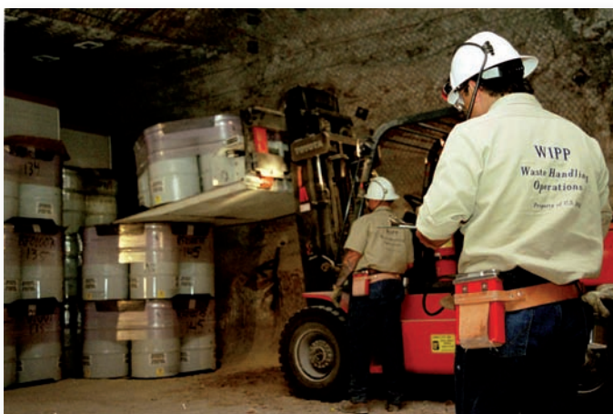
▲ Fig. 3: CH Waste Emplacement
