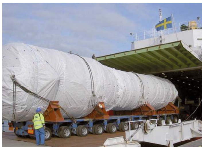
Abb. 30: Transport eines Dampferzeugers nach Schweden zum Einschmelzen
