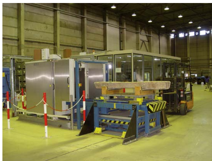
Abb. 33: Messung zur Freigabe von Abfall
