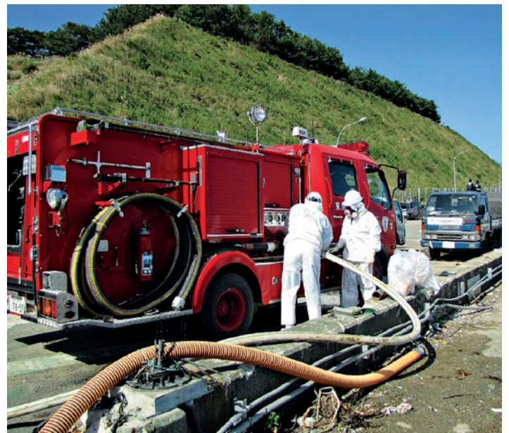
Abb. 3.22: Einspeisung von Seewasser in ein Feuerwehrfahrzeug (Quelle: TEPCO).
