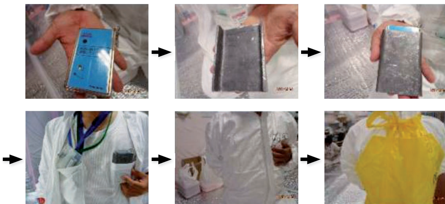
Abb. 5.16: Beispiel für eine entdeckte Manipulation der Messung der Strahlenexposition: Abschirmung aus Blei, in die das APD eingelegt wird, damit das APD eine niedrigere Dosis misst (Quelle: IAE0).
