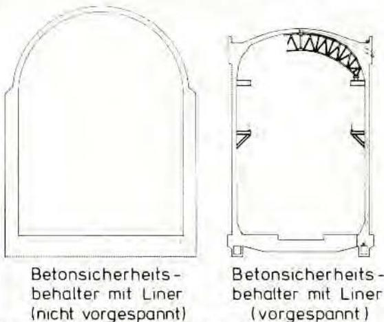
Bild 2: DWR-Sicherheitsbehälter in den USA
