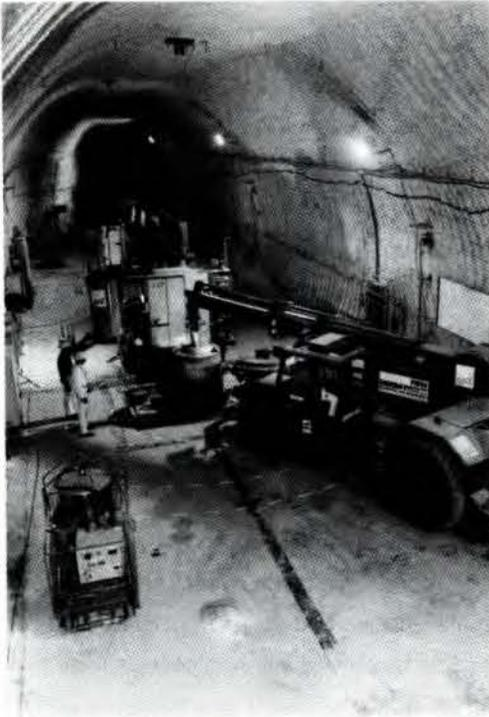
Kalterprobung - ohne Verwendung von radioaktiven Substanzen - des HAW-Transport- und Einlagerungssystems. (Foto: Gramann)
