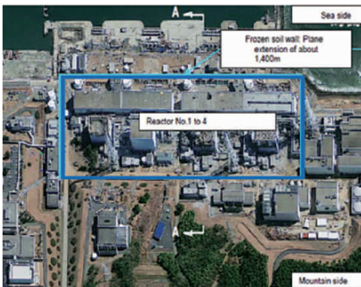
Abb. 6.15: Geplante Lage des sog. »Eiswalls« (Quelle: TEPCO).
