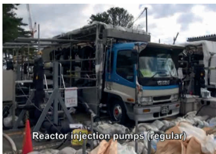
Abb. 6.1: Reaktoreinspeisepumpen und Ersatzaggregate (Quelle: TEPCO).
