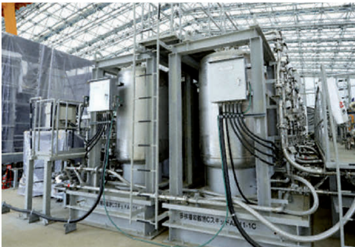
Abb. 6.8: Blick in die sog. Multinuklidanlage (ALPS). Im Bildvordergrund sind sog. »adsorption towers« zu sehen, in denen durch Verwendung verschiedener adsorbierender Materialien dem durchgeleiteten Wasser Radionuklide entzogen werden (Quelle: TEPCO).
