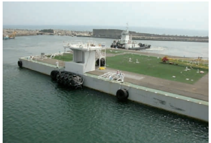
Abb. 6.9: Das »Megafloat«, das zur Lagerung von kontaminiertem Wasser genutzt wurde, wird in den Hafen der Anlage geschleppt (Quelle: TEPCO).
