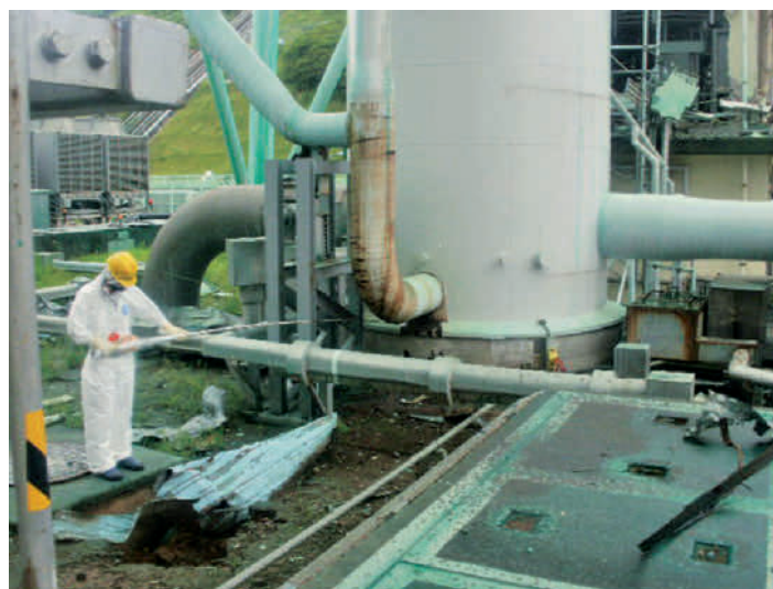
Abb. 5.6: Messung der Ortsdosisleistung mit einem Teleskopdetektor am Abluftkamin der Blöcke 1 und 2 (Quelle: TEPCO).
