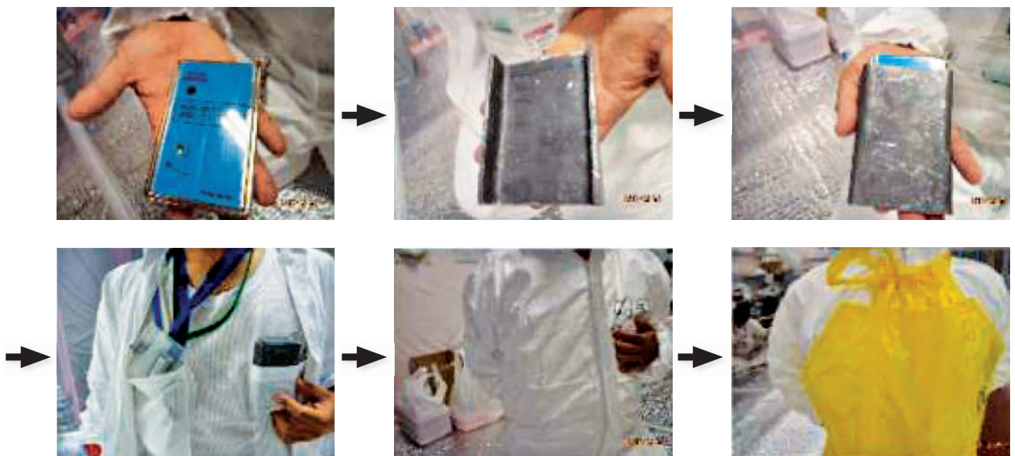
Abb. 5.15: Beispiel für eine entdeckte Manipulation der Messung der Strahlenexposition: Abschirmung aus Blei, in die das APD eingelegt wird, damit das APD eine niedrigere Dosis misst (Quelle: IAEA).
