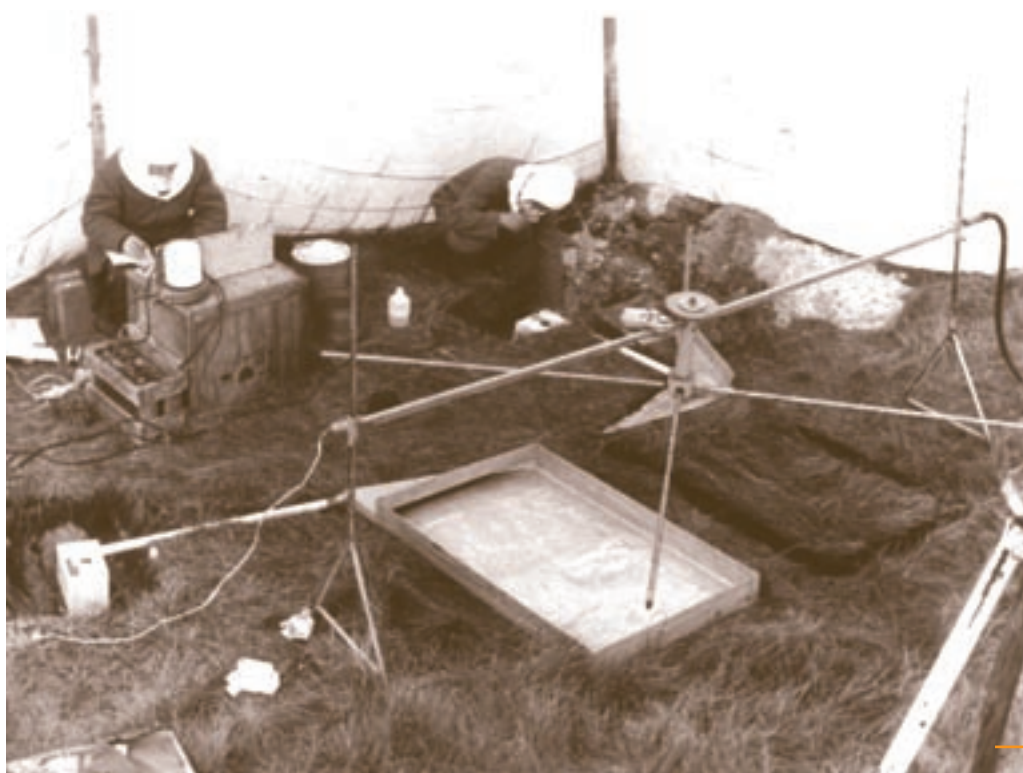
Mikro-Plot im Freien zur Bestimmung des oberflächigen Regenablaufes
