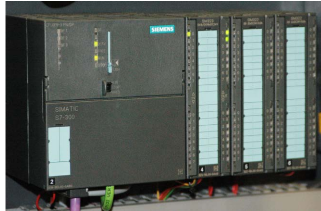
Prozesssteuerungskomponente Siemens Simatic S7-300 (Foto: Wikimedia Commons / Ulli1105)
