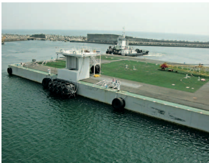
Abb. 6.3: Das »Megafloat«, das zur Lagerung von kontaminiertem Wasser genutzt wurde, wird in den Hafen der Anlage geschleppt (Quelle: TEPCO).
