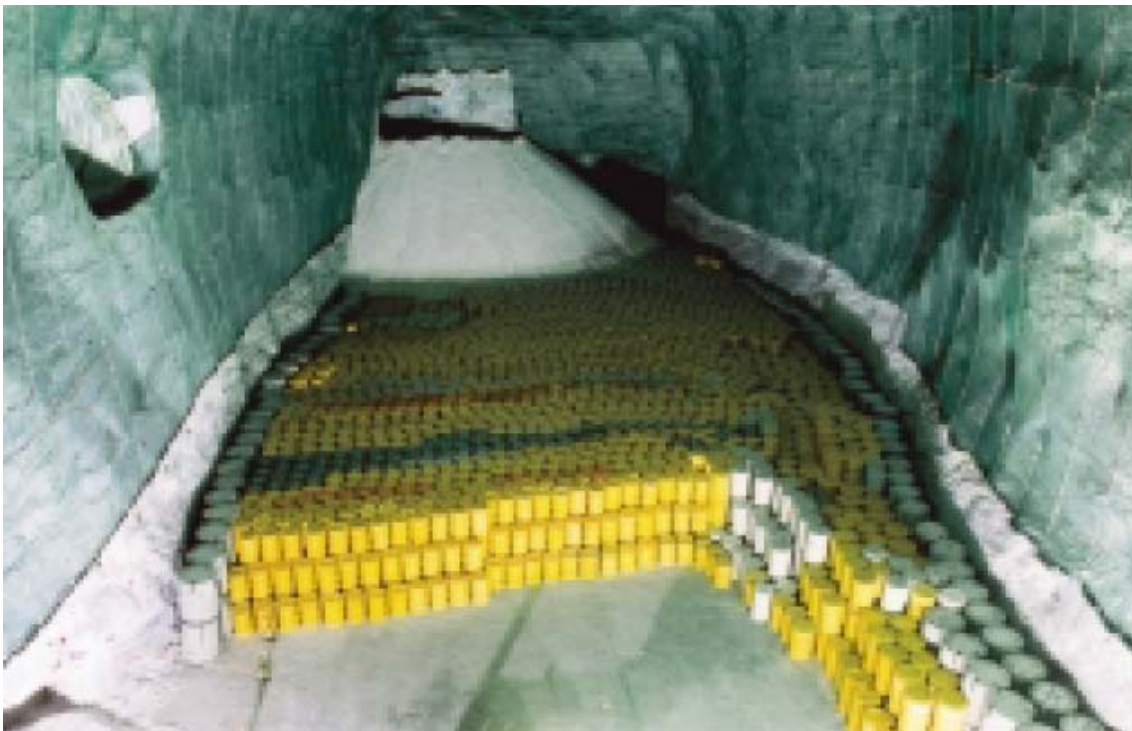
Abb. 19 ERA Morsleben: Einlagerungshohlraum mit gestapelten Fässern im Ostfeld der Grube Bartensleben /BFS 01/
