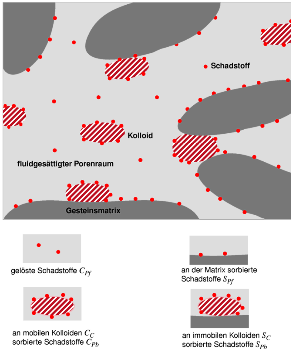
Abb. 9 Mögliche Transportmechanismen beim kolloidalen Transport /LÜH 99/
