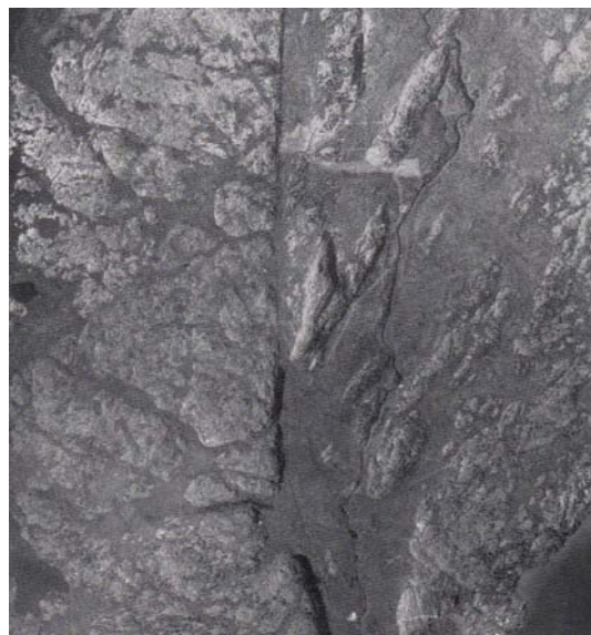
Abb. 22 Reliefausdruck einer größeren Störung im Grundgebirge (Luftbild). Weniger bedeutende Störungen und Klüfte sind durch geradlinige Vegetationsreihen angedeutet /KRO 67/
