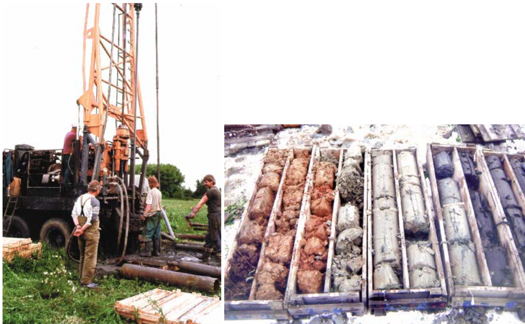
Abb. 25 Bohrgerät für Drehbohren, im Vordergrund Kernrohr (links); Kernkisten mit Bohrkernen (rechts), unterschiedliche geologische Einheiten lassen sich hier beispielsweise schon aufgrund ihrer Farbe differenzieren
