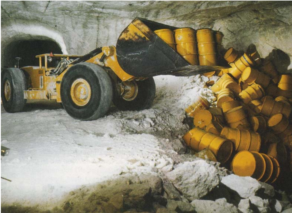
Abb. 33 Versuchseinlagerung von schwachradioaktiven Abfällen - Abkipptechnik in Kammer 7 auf der 725-m-Sohle /GSF 95/
