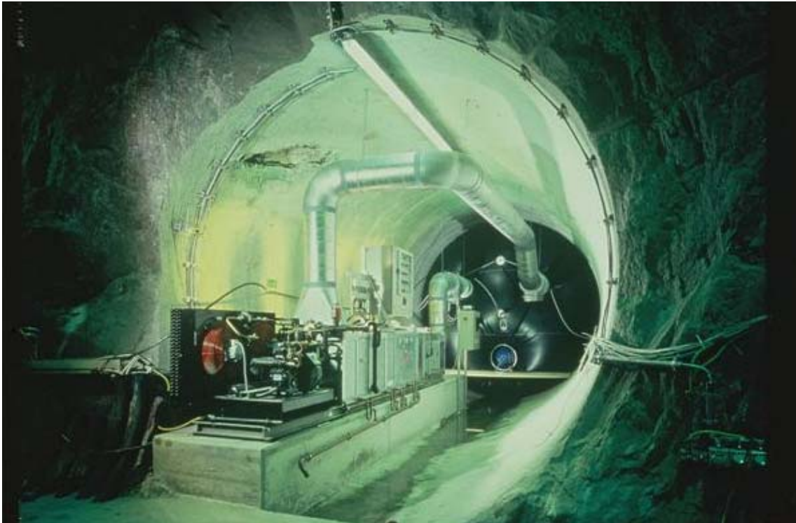
Abb. 6 Aufbau des Ventilationstests im Felslabor Grimsel zur Ermittlung des Gebirgsfeuchteintrags in einen abgedichteten Streckenabschnitt. Der eigentliche Messabschnitt ist durch ein Bergwerksskissen vom übrigen Stollensystem abgedichtet. Vorn die Klimaanlage zur Auskondensierung der im abgedichteten Streckenabschnitt aufgenommenen Feuchte
