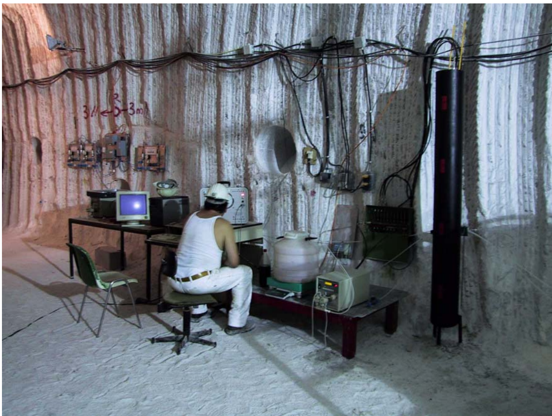
Abb. 47 In situ-Versuch mit „Selbst Verheilendem Versatz (SVV)“ in der Schachanlage Asse in Bohrlöchern von 15 m Länge und 50 cm Durchmesser
