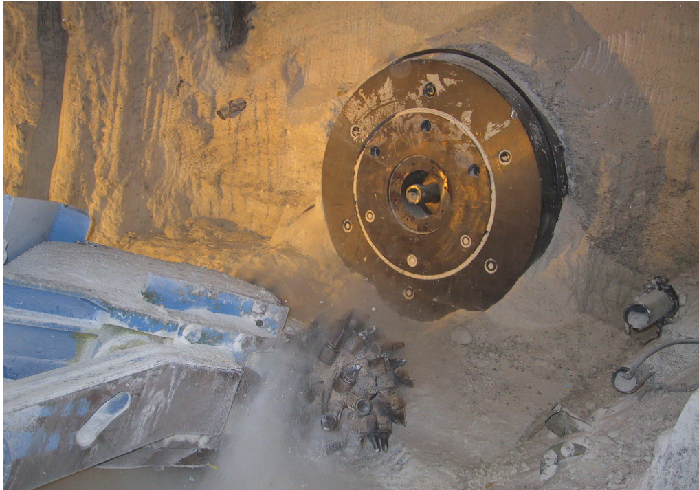
Abb. 43 TSS-Versuchsfeld: Wiederauffahrung einer Versuchsstrecke
