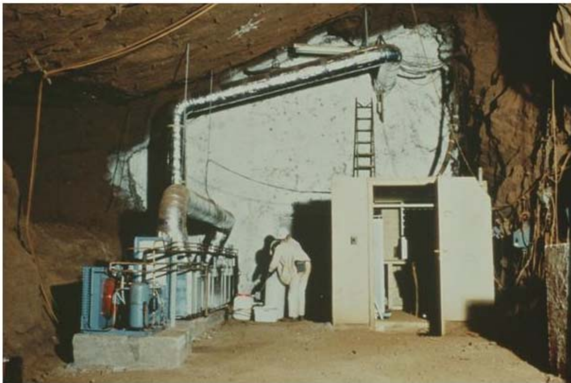
Abb. 21 Der Ventilationstest in der Schachtanlage Konrad zur Ermittlung des Gebirgsfeuchteeintrags in einen abgedichteten Streckenabschnitt
