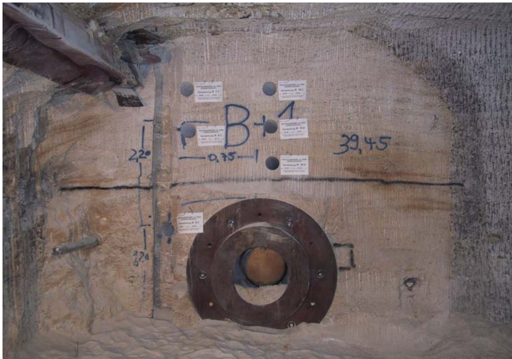
Abb. 44 TSS-Versuchsfeld: Probenahmestellen im kompaktierten Versatz
