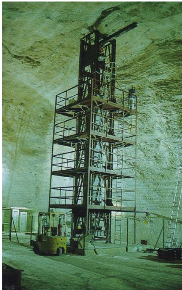
Abb. 45 Versuchsanlage für Schüttgutuntersuchungen an Versatzmaterialien auf der 490-m-Sohle der Schachanlage Asse /GSF 95/
