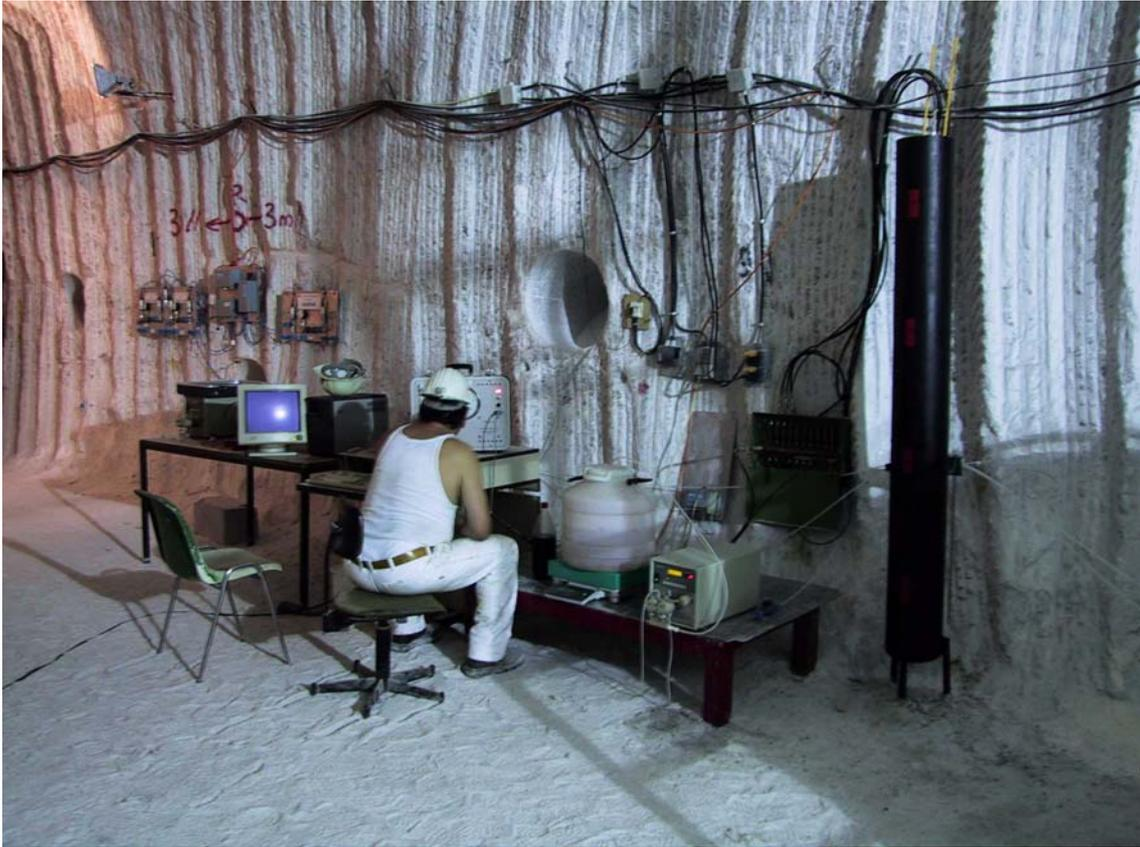
**Abb. 8** In-situ-Versuch mit „Selbst Verheilendem Versatz (SVV)“ in der Schachanlage Asse in Bohrlöchern von 15 m Länge und 50 cm Durchmesser
