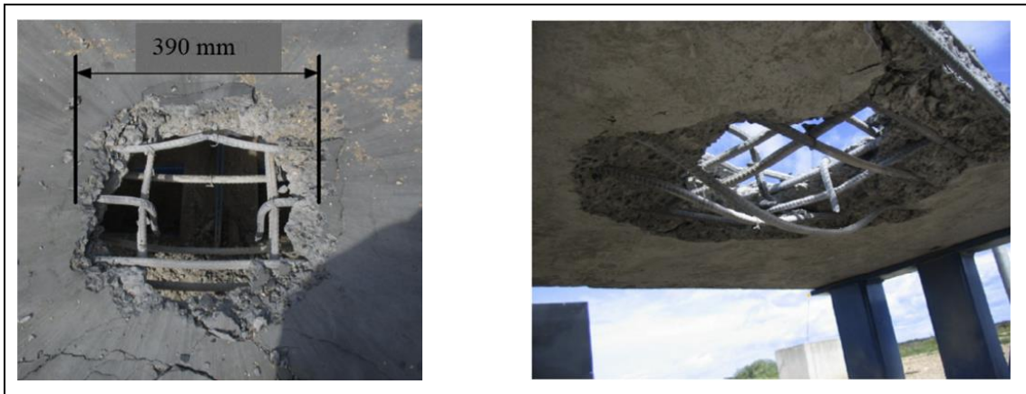
Abb. 8.39 Front- und rückseitige Schadensbilder im Sprengversuch mit aufgelegter Ladung nach /LIJ 15/
