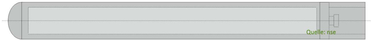
Abb. 5.5 DBC-R: Entwurf eines rückholbaren Abfallbehälters für eine tiefe Bohrloch-lagerung
