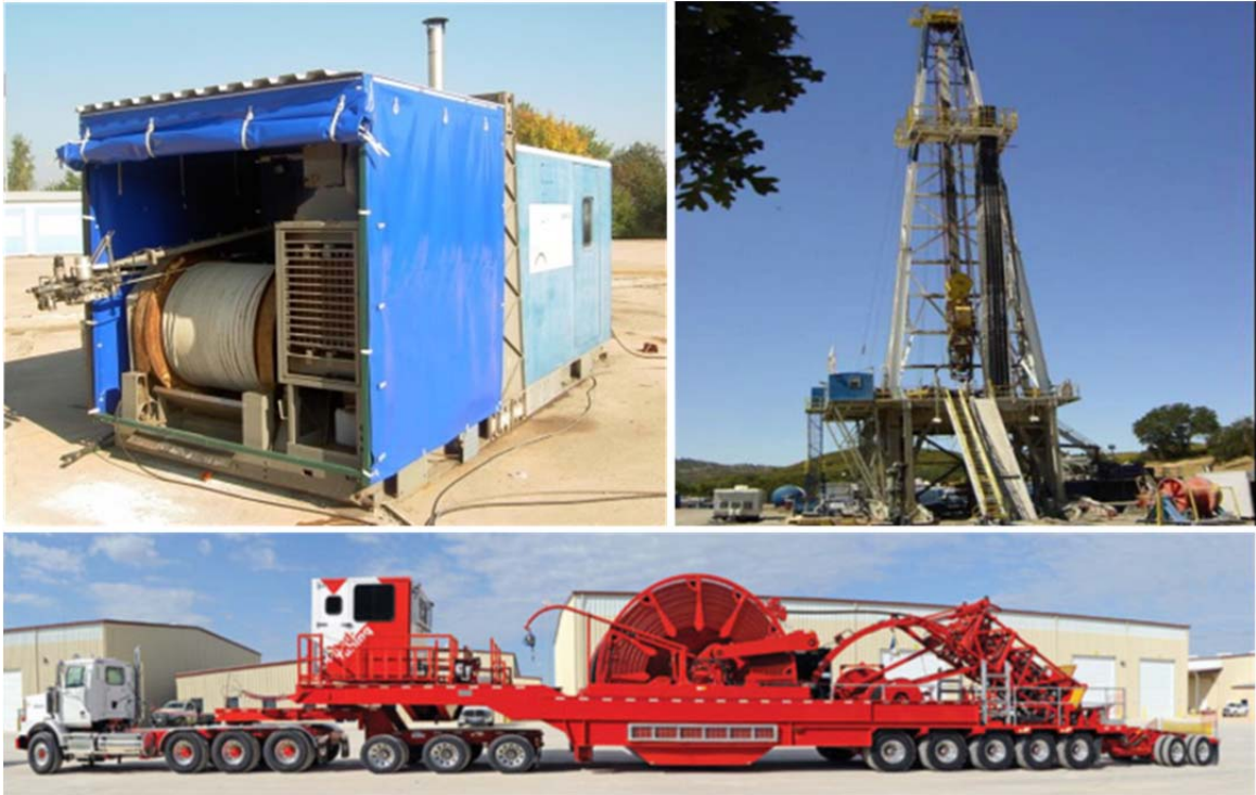
Abb. 5.10 Einbringungs- und Rückholungsverfahren mit Kabelwinde (links, oben), Coil Tubing Unit (mitte, unten) und Gestänge durch einen Bohrturm (rechts, oben)
