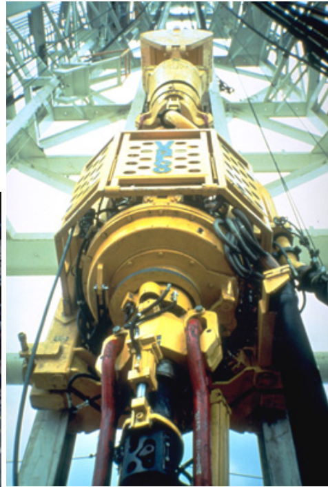
Abb. 4.3 links: Drehtisch und Mitnehmerstange („Kelly“) rechts: Kraftdrehkopf (Topdrive) (Abbildungen aus /SCH 16/)
