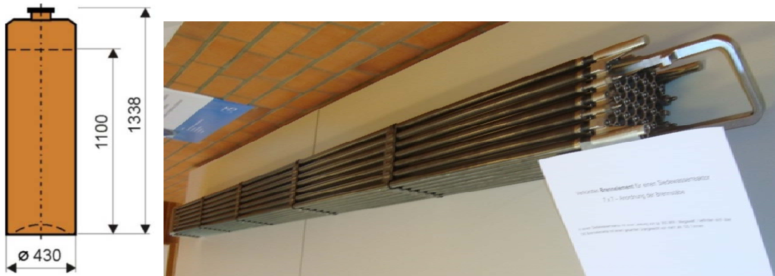
Abb. 5.1 HAW-Kokille nach /THO 09/ und Brennelementmuster (eigene Aufnahme)
