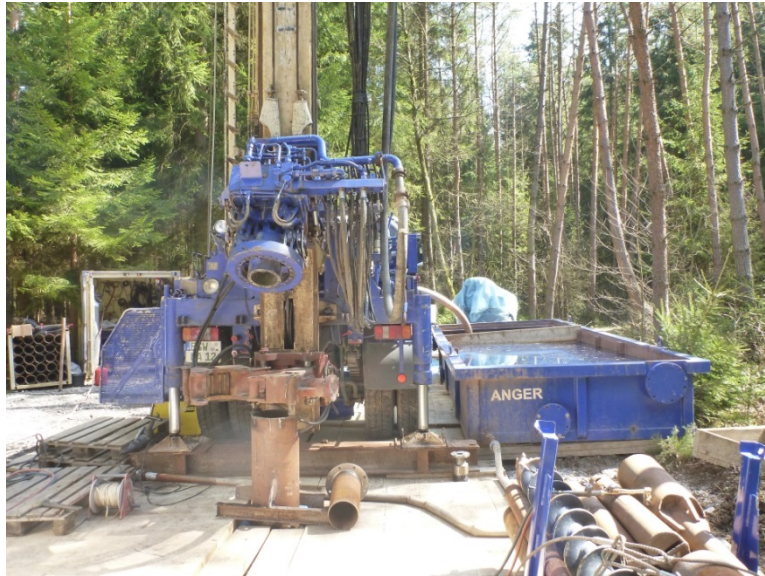
Abb. 8.1 Bohrgerät für die Aufschlussbohrung im quartären Maar bei Neualbenreuth (Foto F. Nützel, Piewak & Partner GmbH)
