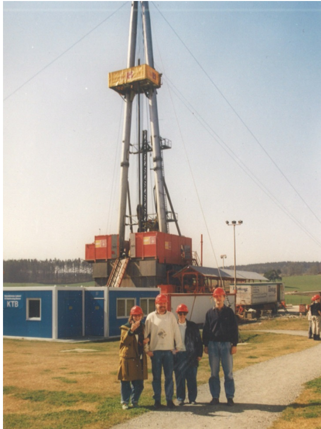
Abb. 4.11 Bohranlage GH 1400E für die KTB-Vorbohrung
