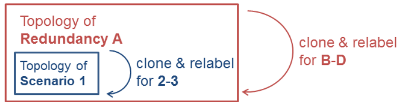
Abb. 3.7 Prinzip der automatisierten verschachtelten Duplikation von Fehlerbaum-Topologien zur Modellierung verschiedener Überflutungsszenarien (blau) mit redundanzübergreifendem Einfluss (rot)
