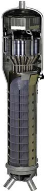
Abb. 4.2 Aufbau eines EPR-Dampferzeugers
