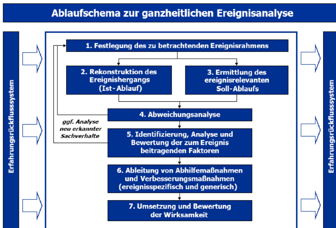
Abb. 3.4 Ablaufschema einer Ereignisanalyse nach /RSK 08/ (Quelle: Reaktorsicherheitskommission)
