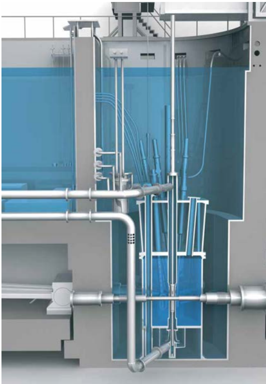
Abb. 3.9 Vertikaler Schnitt durch das Reaktor- und Absetzbecken des FRM II. Quelle: /TUM 09/
