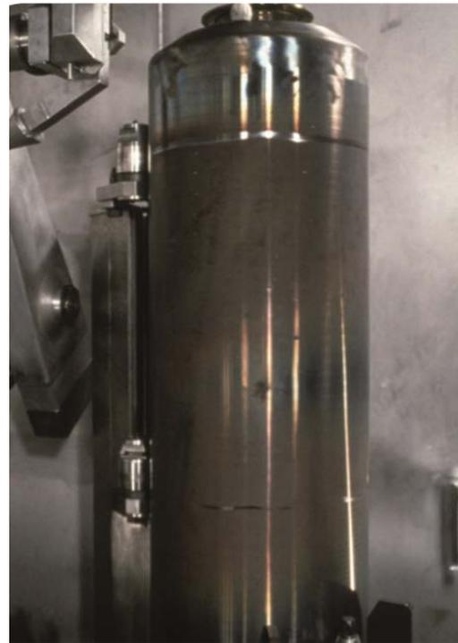
**Abb. 2.5** Automatische Verschweißung einer HAW-Graskokille /DAf 18/
