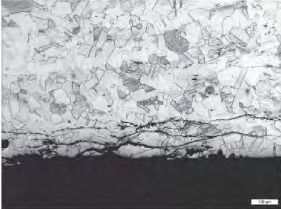
Bild 3.14: Transkristalline Rissbefunde im untersuchten Armaturengehäuse
