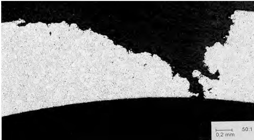
Bild 3.24: Kernkraftwerk Biblis B: Wanddurchdringung im Dampferzeuger-Heizrohr mit Leckage infolge Rohrbodenreinigung
