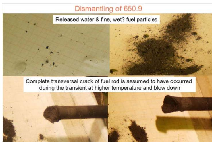
**Abb. 5-3** Brennstoff-Körnung am Ende des Versuchs IFA650.9
