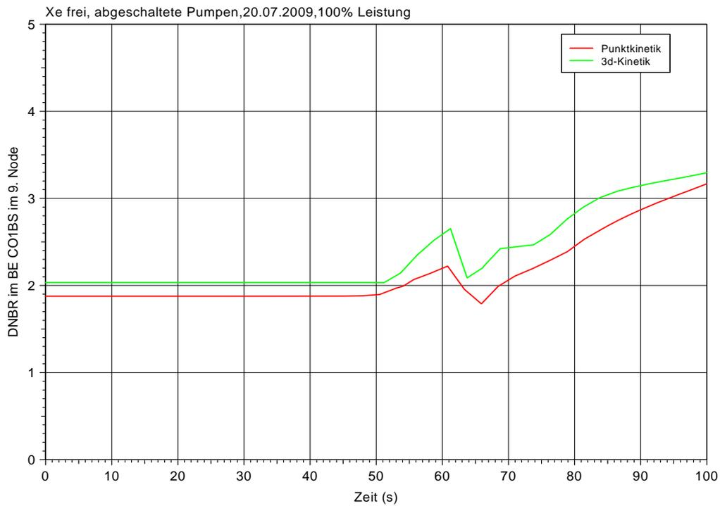
**Bild 3-19** Xenonfreie Rückwirkungen, abgeschaltete Pumpen, 100 % Leistung, Vergleich DNBR
