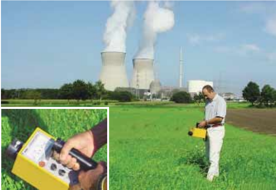
Experten überprüfen regelmäßig die Umgebung der Kernkraftwerke auf radioaktive Stoffe u.a. mit einem Gerät zur Messung der Ortsdosisleistung (links im Bild vergrößert dargestellt)
